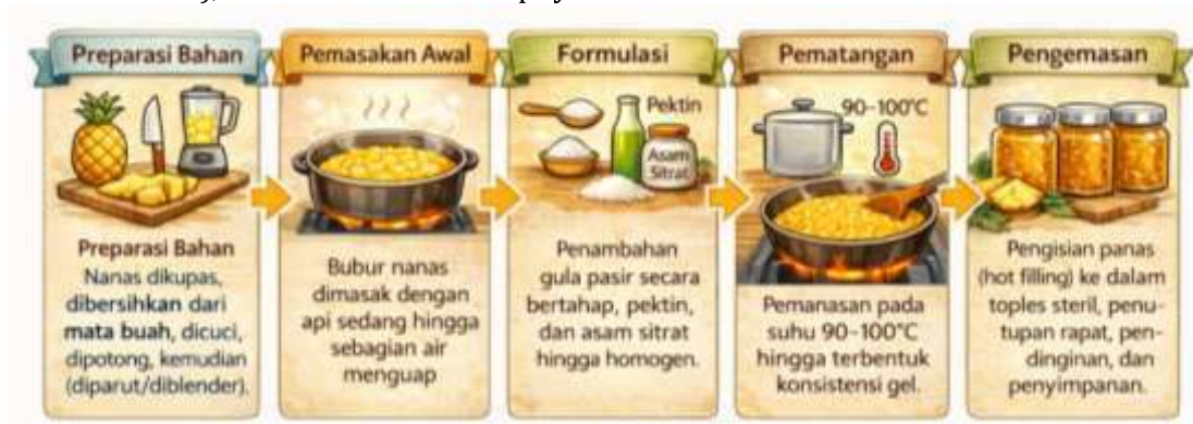
Gambar 1. Tahapan proses pembuatan selai nanas
