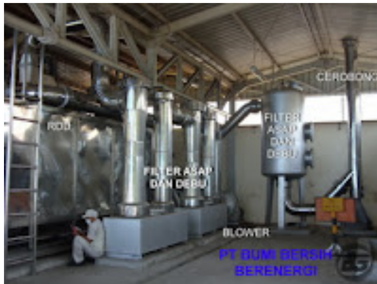
Gambar 5. Konstruksi Mesin Rotary Drum Dryer (RDD) Pengolahan Sludge Susu Di PT. Morinaga.
