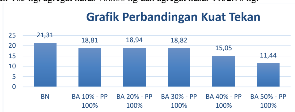
Gambar 6 Grafik Hasil Pengujian Kuat Tekan Beton
